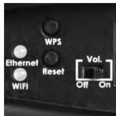
e) Vérifier que la diode bleue WiFi à l'arrière du Stream Source clignote.
