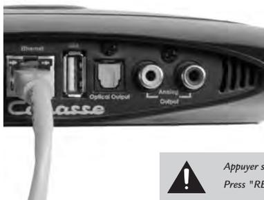
Connecter un câble RJ45 entre le Stream Source et votre routeur (ou Box Internet). La connexion est établie quand la diode ETH passe au bleu fixe.
