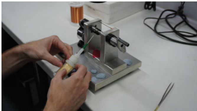
Spolene til MC pickup-ene lages for hand med en spoletråd som kun er en tredjedel av et hårstrå. Vanskelig jobb.
